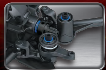
Bellcrank Steering with integrated servo saver Direction à levier coudé avec sauve-servo intégré Dirección de palanca acodada con ahorrador servo integrado Winkelhebel-Lenkung mit integriertem Servo-Saver
