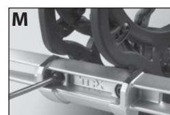
3. Montez le pare-chocs arrière ainsi modifié sur les montants du support d'aileron (M).
