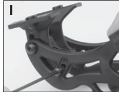
**Montage d'un aileron sur le support de carrosserie**
