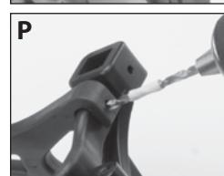
Spitze entfernt, damit Sie nicht tiefer als 6,35 mm (1/4") bohren. Wenn Sie mit einer Bohrmaschine bohren, befolgen Sie die Anweisungen des Herstellers und tragen Sie auf alle Fälle eine Schutzbrille.
