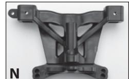
2. Verifique que la parte superior de la estructura del alerón quede nivelada y a una distancia uniforme en la estructura.
