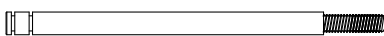
AX30146 (x4) Shock shaft, 3 x 50mm Kolbenstange, 3 x 50 mm Bras d'amortisseur, 3 x 50 mm Albero ammortizzatore, 3 x 50 mm
